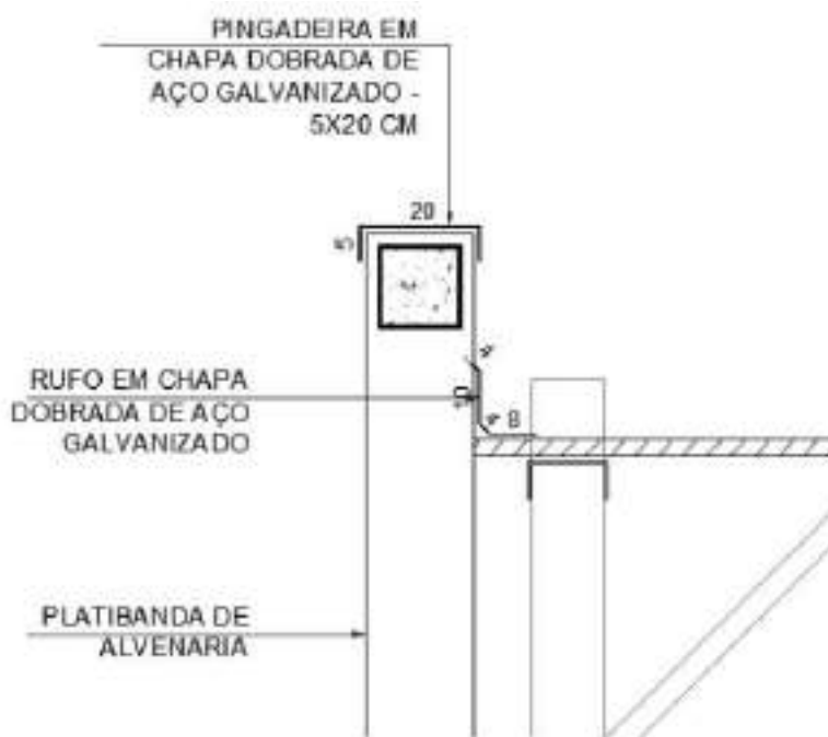
Figura 43 – imagem exemplificativa de detalhe de rufo/alvenaria e pingadeira
